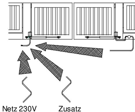
Bild 9 Anschluß der Antriebe
