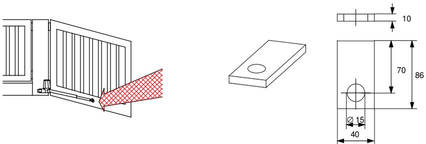
Bild 8 Anbauteil Torflügel
