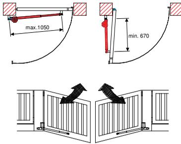
Bild 3 Funktionsweise des Antriebs
